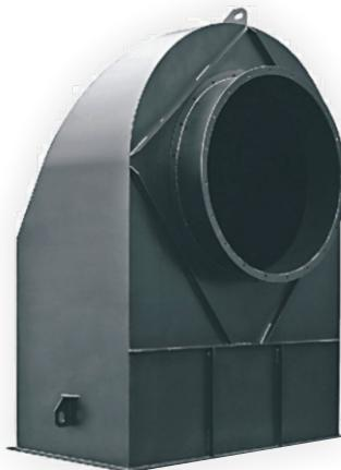
Перенаправляют потоки газопаровоздушной смеси перед тягодутьевой машиной на угол 90°, в условиях, когда отвод в газовом тракте должен отступать от входного отверстия тягодутьевой машины на расстоянии менее 3 диаметров воздуховода. Это позволяет снизить потери давления.
