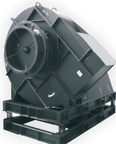
Служат для подачи воздуха в котлы: водогрейные, газомазутные, пылеугольные (производительностью от 2,5 до 25 т/час), котлы-утилизаторы, а также в качестве элемента системы вентиляции и кондиционирования в производственных помещениях. Применяются в котельных, на теплоэлектростанциях и в других отраслях.
