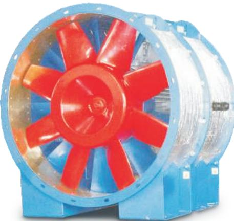
Функционируют в составе приточных систем дымоудаления служат для снижения неблагоприятных последствий после пожаров. Вентиляторы осевые ВО 25-188 создают избыточное давление и осуществляют приток атмосферного воздуха на лестничные клетки, в тамбуры-шлюзы, шахты лифта и другие помещения, прилегающие к месту возгорания. Это способствует предотвращению пожара и проведению спасательных работ.
