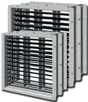
Устройства перекрытия вентиляционных каналов (УПВК) защищают вентиляционные проемы в сооружениях, установленных в строительных конструкциях и в воздуховодах вентиляционных систем АЭС, от воздушной ударной волны в случае детонационного взрыва.
