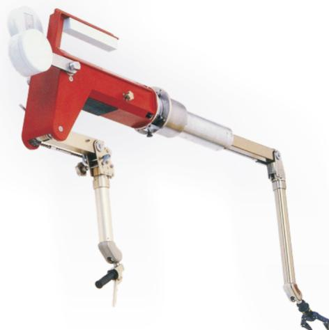
Шарнирные манипуляторы предназначены для выполнения ручных работ с преимущественно радиоактивными материалами за защитными стенками из бетона, свинца или стали, возможно при использовании защитной камеры. Относительно их многообразия, универсальные устройства дистанционного управления заменяют руки за защитными стенами и специальные устройства управления, применение которых становится обязательным. Они предназначены для лёгких и сложных работ.
